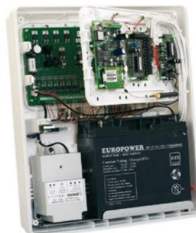
Exemple de configuration du matériel pour boîtier **OPU-3 P****OPU-2 A**
