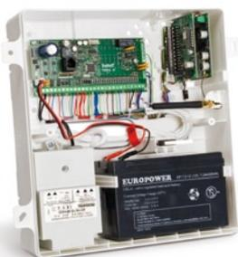
Exemple de configuration du matériel pour boîtier **OPU-4 PW****OPU-3 P**
